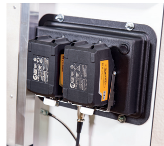
Zwei leichte Li-Ionen Akkus direkt am Gerät montiert
